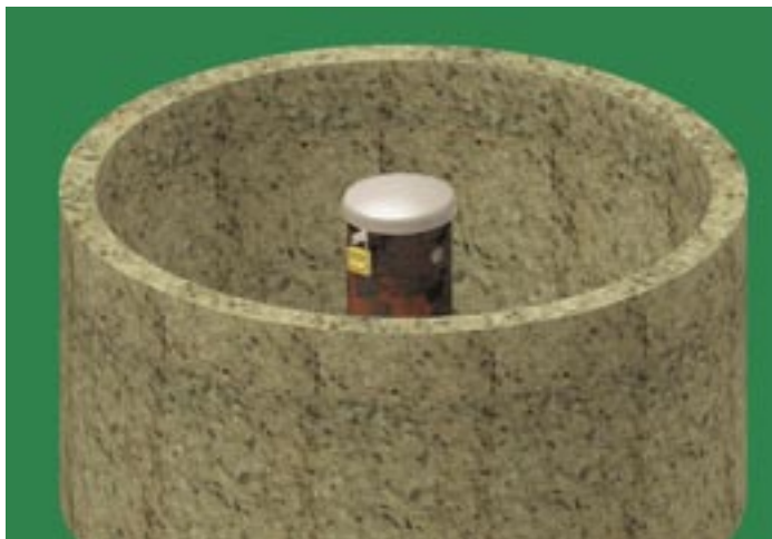
Högst upp på betongplinten placeras en mät dubb för det GPS-instrument som ska registrera markrörelser. Runt mätplinten placeras en betongring som skydd mot yttre åverkan. (bild: LKAB)
